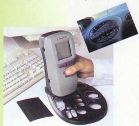
本機光學幾何結構(Optic geometry)為d/8°，積分球設計是目前最新趨勢的設計，再配合較穩定的氙弧燈(Xenon flash)光源，如此，可提昇測色時的準確性與再現性。
